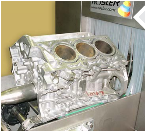
V6 Motorblock auf umlaufendem Doppelketten - Transportsystem
