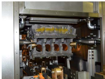
Blick auf den rotierenden Motorblock in der End-Abblaspphase
