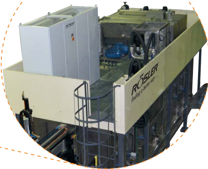
Blick auf das Obergeschoss, in dem Wärmetauscher, Kälteaggregate, Lagertanks und Mitteldruck- Pumpen installiert sind.
