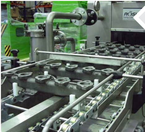
Transport von Werkstücken in „V“-Aufnahmen zum Waschen und Trocknen
