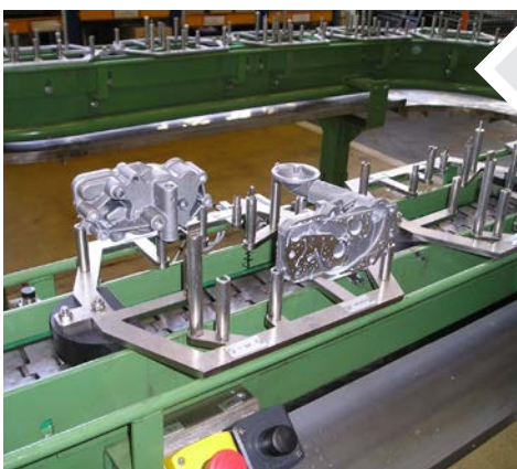
“Flex on line” System zum Transport von Werkstückaufnahmen
