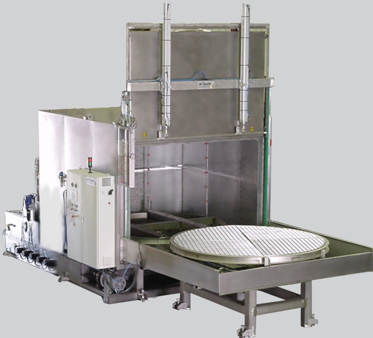
Waschkabine für sehr große Werkstücke, z.B. Getriebe für Windkraftanlagen (1.500 kg) Abmessungen der Kabinentür: 2.400 (B) x 1.500 (H) mm
